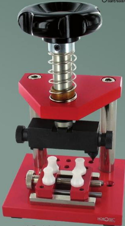
Z07-320 110x95x175mm Pour ouvrir et fermer les fonds à visser Livrée avec un jeu de 4 mors différents
