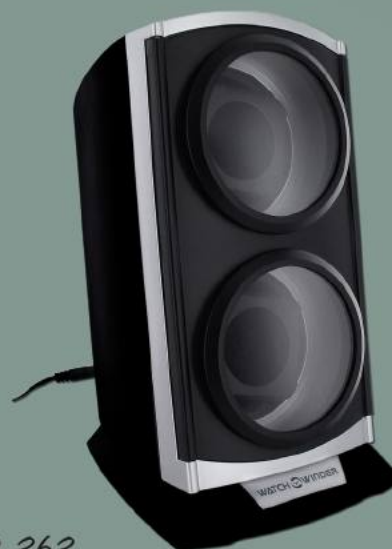
Z19-363 Appareil de remontage économique pour 2 montres Plastique noir Interrupteur 3 positions de rotation (droite-bidirectionnel-gauche) Mode A : remontage 33 secondes puis pause de 12 minutes Mode B : remontage 10 minutes puis pause de 90 minutes Mode C : remontage 30 minutes puis pause de 3 heures Mode D : remontage 1 heure puis pause de 3 heures Dimensions : ht: 25,5 cm - Larg: 14 cm - Prof: 15 cm Fonctionne sur secteur uniquement
